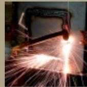
ProGuard telah memenuhi standard EN 1143-1 dari ECB-S (European Certification Board of Safety) untuk proteksi dari pencurian grade III. Pengujian ketahanan ini menggunakan berbagai macam peralatan pembongkaran paksa, mulai dari peralatan sederhana seperti palu hingga peralatan termal dan elektrik.
